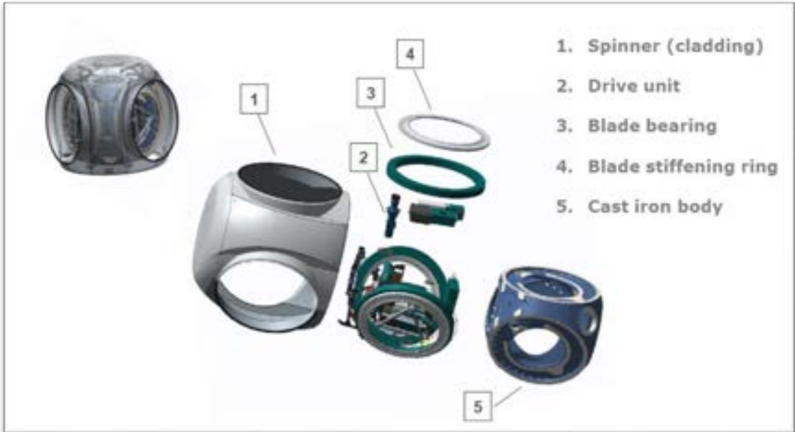
Şekil 5.21 Hub Elemanları
