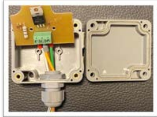
Şekil 2.10 Basınç Sensörü Dış ve İç Görüntüsü
