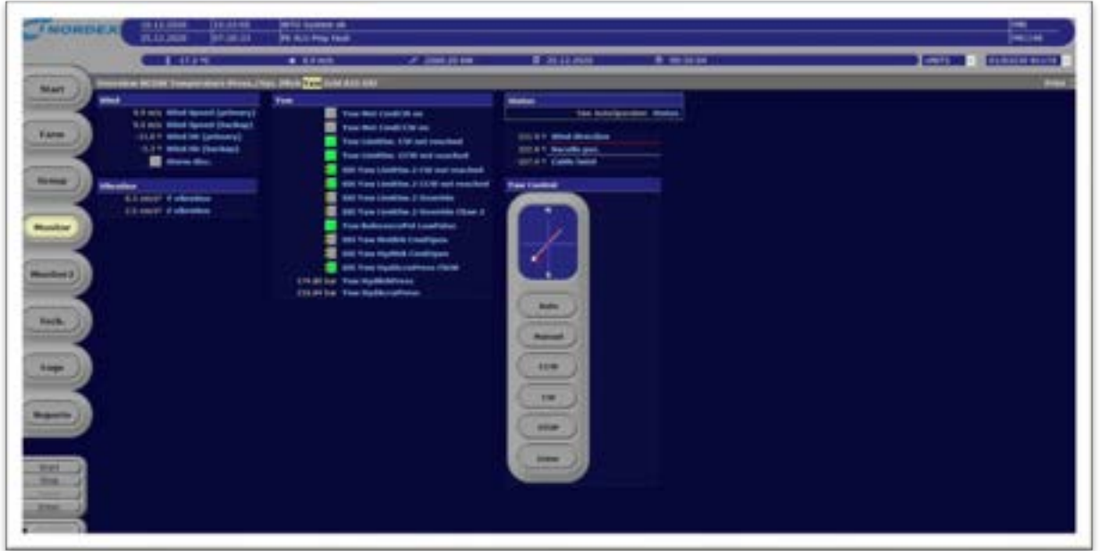
Şekil 5.35 Naselin Oryantasyonu (Rüzgâr Yönüne Göre)
