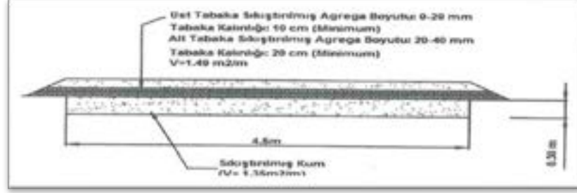
Şekil 6.4 Ulaşım Yolu Yapımı
