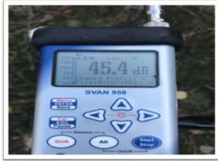
Şekil 10.8 Türbin Çalıştığı Zaman Ölçüm Değeri L_{N+S} = 45.4 \text{ dBA}
