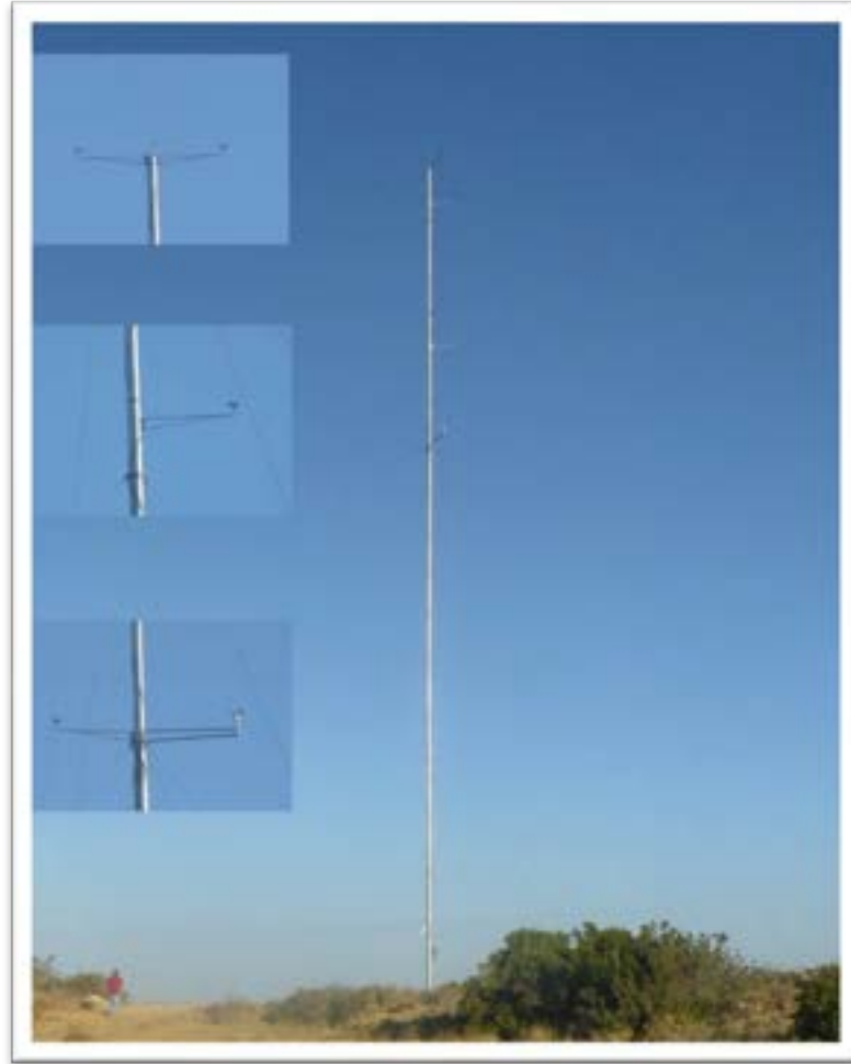
Görsel 3.23 50 Metre Boru Tip Ölçüm Direği
