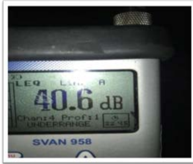
Şekil 10.7 Türbin Çalışmadığı Zaman Ölçüm Değeri L_N = 40.6 dB
